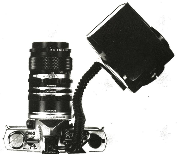
Kamerahusets fotoceller, der også måler på filmen under eksponeringen, styrer her en speciel computerflash. Det er en stor hjælp ved makrooptagelser og ved diakopiering.
